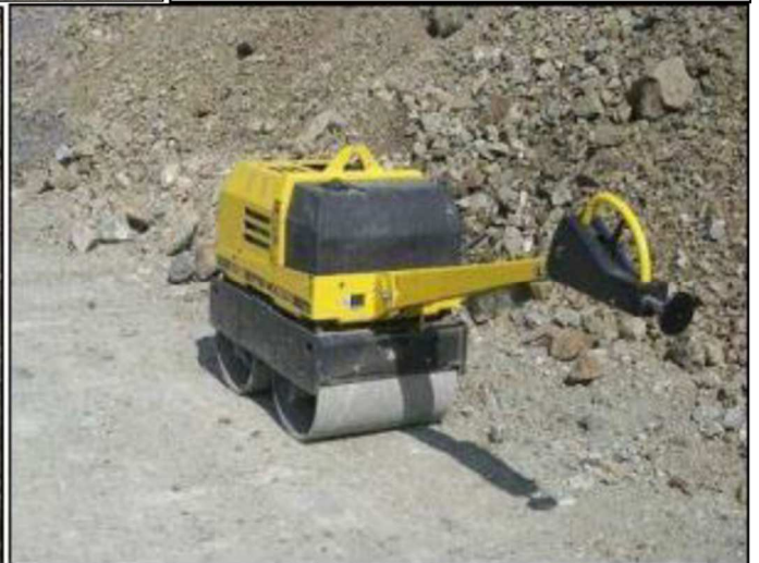
33 pav. Šalia sienos (1,0 m atstumu) turi būti naudojami mažo svorio tankinimo įrenginiai.
