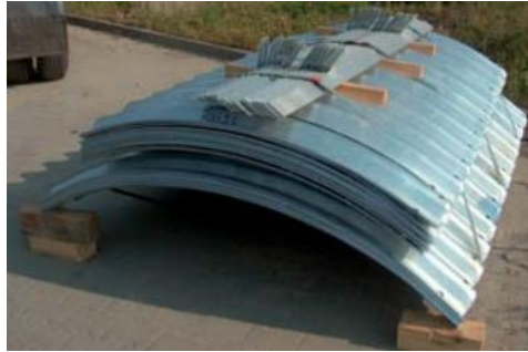
3 pav. Plieninių lakštų sandėliavimas
